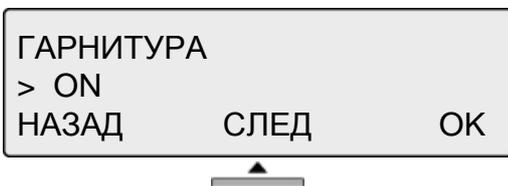
Нажимайте [СЛЕД] или
